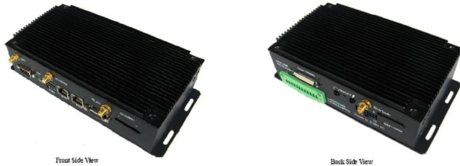
LINK-QK，是一款以 Intel Quark 400MHz/533MHz CPU 为核心，支持 3G、WiFi、蓝牙、GPS、ZigBee 等多种无线通讯方式的高性能、高可靠、无风扇的工业级嵌入式互联网终端设备。
